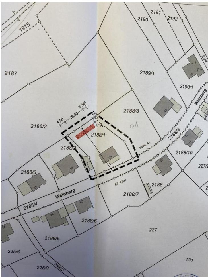
Die PV-Anlage soll auf Grund der Geländebeschaffenheit außerhalb des Baufensters errichtet werden.
